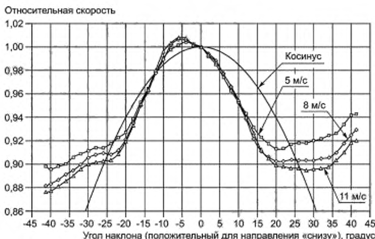
Рисунок J.1 — Измеренные угловые характеристики чашечного анемометра в сравнении с косинусной реакцией
