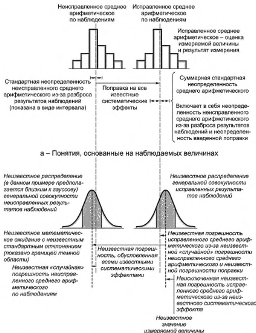
Рисунок D.1 — Графическая иллюстрация понятий «значение», «погрешность» и «неопределенность»
