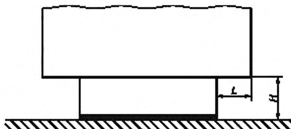
Рисунок А.14 — Размещение машины на полу с возможностью доступа в пространство L
