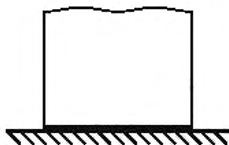
Рисунок А.13 — Размещение машины на полу
