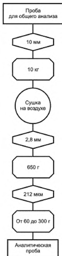
Рисунок 11 — Пример схемы приготовления пробы для общего анализа
