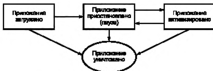
Рисунок 5 — Модель состояний виртуальной машины Xlet
