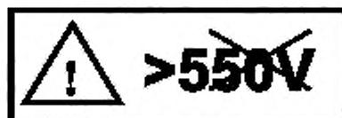
Пиктограмма и ее контуры должны контрастировать с основным фоном. Значение напряжения, указанное на маркировке, должно превышать значение максимального напряжения между фазами в 1,1 раза.
