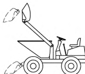
Рисунок 22 — Загрузка вспомогательным ковшем
