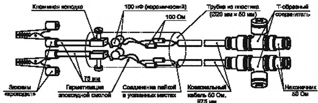
Рисунок А.1 — Испытание дифференциальным измерением
