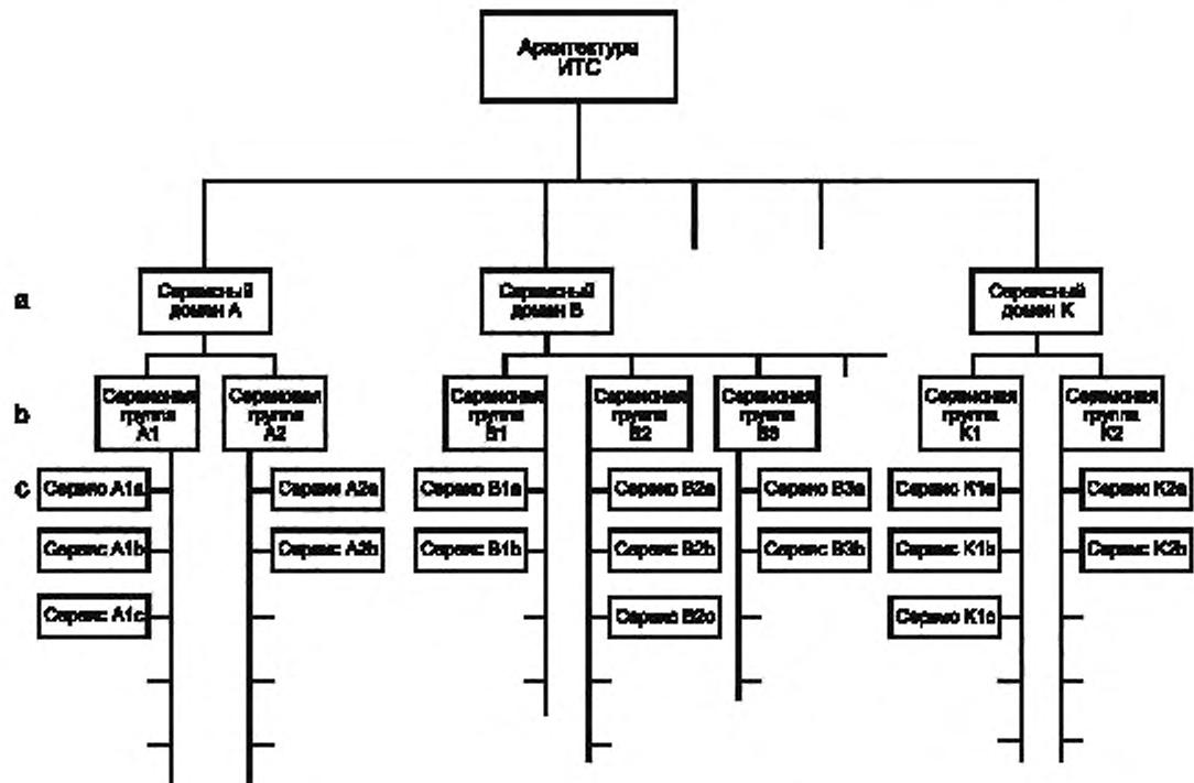
Рисунок 1 — Иерархия построения архитектуры ИТС
