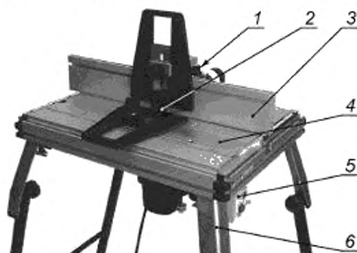
1 — выхлопной патрубок; 2 — вставка стола; 3 — параллельная направляющая; 4 — верх стола; 5 — выключатель с вилкой и розеткой; 6 — основной корпус
