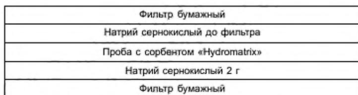
Рисунок 5.3 — Схема заполнения экстракционной ячейки для экстракции сырого жира
