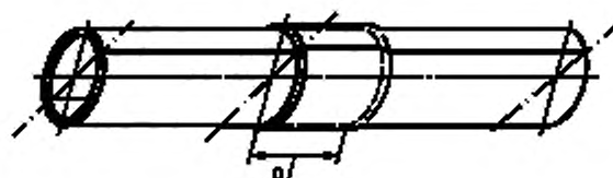
Рисунок D.3 — Контрольное соединение. Муфтовое нахлесточное соединение
