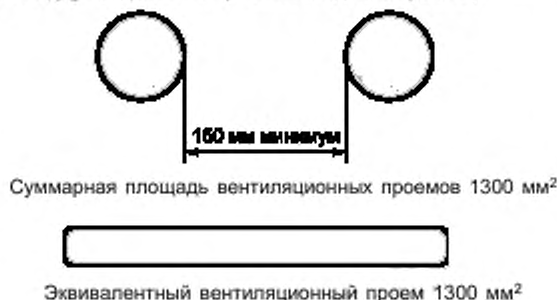
Рисунок 7— Пример разных конструкций вентиляционных отверстий
