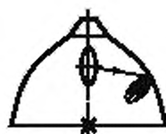
б — зеркальный отражатель, выходное отверстие открыто или с прозрачным рассеивателем, отражение с рассеянием
