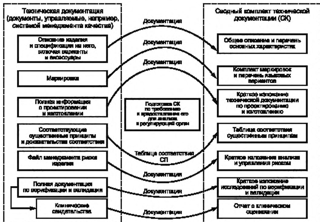
Рисунок 2 — Использование сводного комплекта на послепродажной стадии
