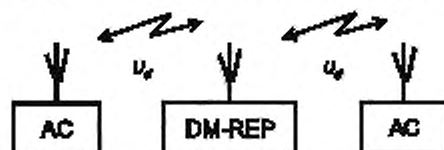
Рисунок 4.5 — Структурная схема организации подвижной радиосвязи с использованием ретранслятора сигналов DMO
