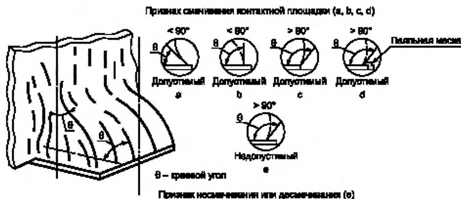
Рисунок 1 — Варианты краевого угла смачивания припоя θ, виды состояний
