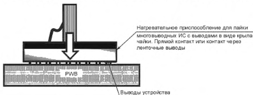
Рисунок 9 — Пайка оплавлением нагретыми термодами
