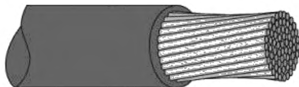
Рисунок 13 — Изоляция проволочного вывода: заданное состояние
