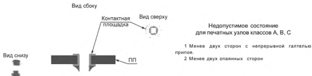
Рисунок 20 — Галтели припоя: недопустимое состояние
