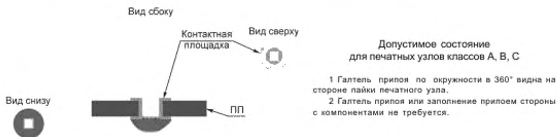
Рисунок 18 — Галтели припоя: допустимое состояние
