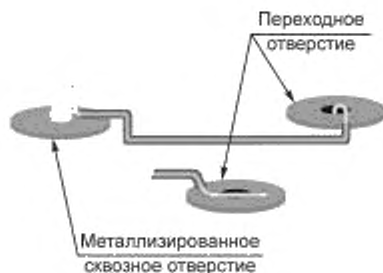
Рисунок 30 — Соединение навесной перемычки с выступающими выводами компонентов и металлизированными отверстиями: виды состояний
