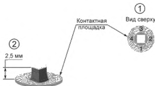
Рисунок 21 — Состояния подъема припоя: виды состояний
