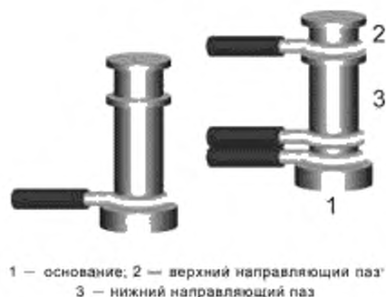
Рисунок 3 — Круговая накрутка провода и вывода: допустимое состояние
