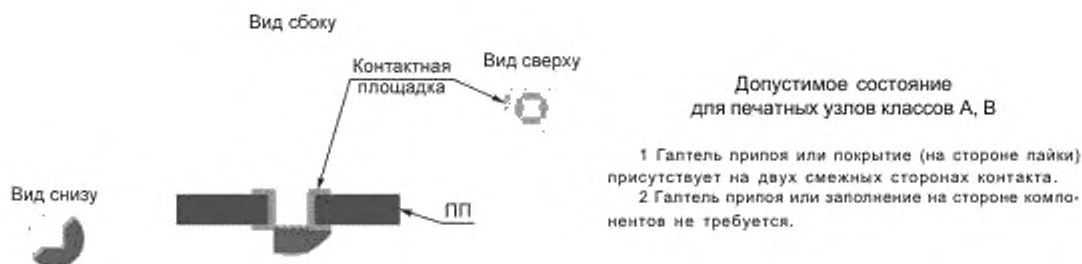
Рисунок 19 — Галтели припоя: допустимое состояние
