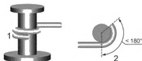
Рисунок 4 — Круговая накрутка провода и вывода: виды состояний
