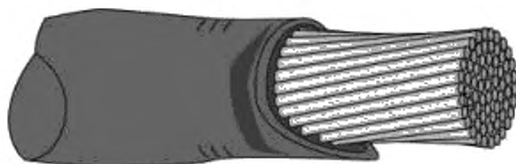
Рисунок 14 — Поврежденная изоляция: допустимое состояние
