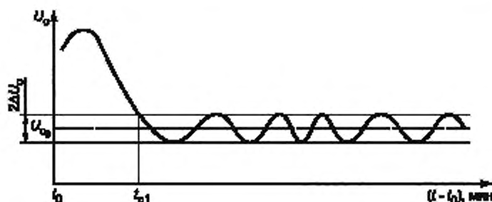
Рисунок 7 — Характеристика стабильности выходного сигнала тепловизора
