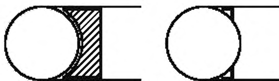
Рисунок 11 — Средства защиты мест затягивания приводным ремнем в ременных приводах
