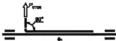
Рисунок 1 — Схема испытания на сопротивление отслаиванию липкого слоя (адгезива)
