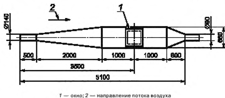
Рисунок 2 — Размеры рекомендуемой испытательной пылевой камеры
