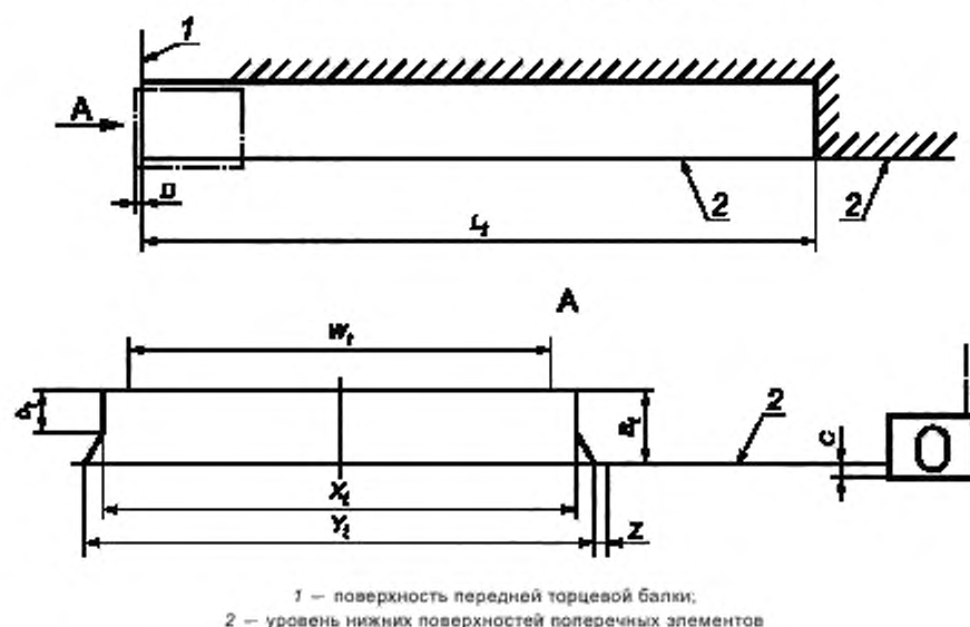
Рисунок Е.1 — Размеры тоннеля контейнера, в который может входить балка типа «шея гуся» полуприцепа
