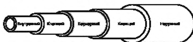
Рисунок 1 — Слои многослойной напорной трубы
