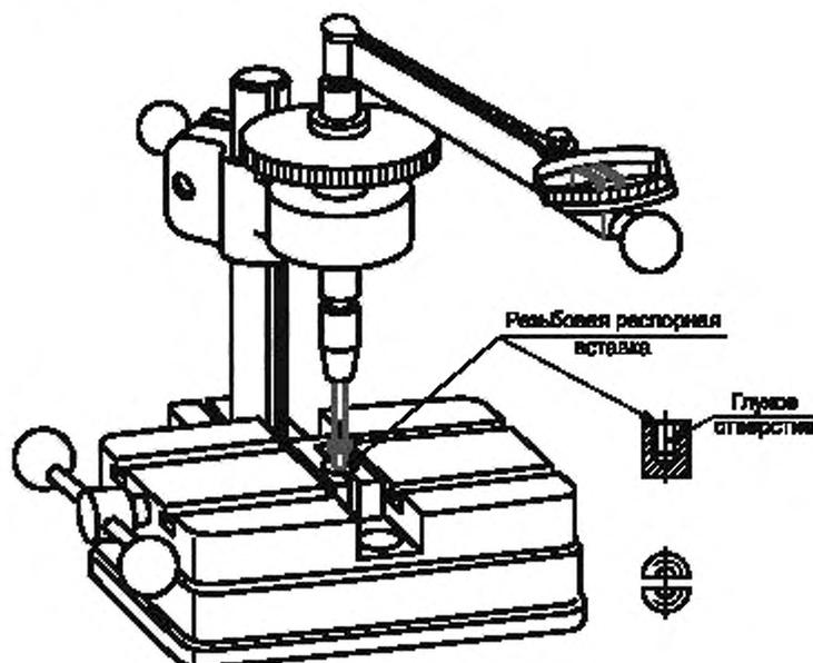
Рисунок 1 — Пример устройства для испытания на кручение
