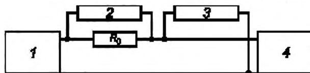
1 — генератор низкочастотных сигналов, 2, 3 — измерители уровня или напряжения; R_0 — сопротивление 100 Ом; 4 — измеряемое звено
