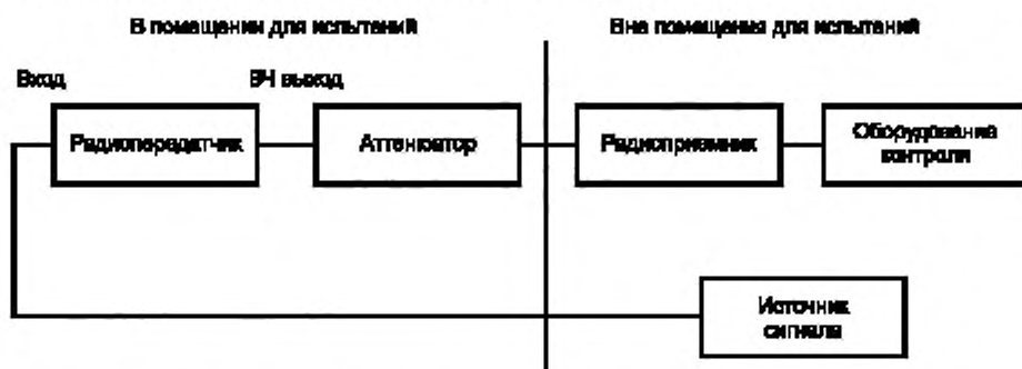
Рисунок 3 — Схема соединений испытываемого радиопередатчика и вспомогательного оборудования при проведении испытаний на помехоустойчивость
