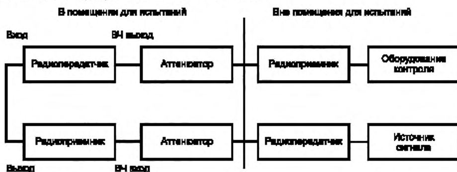
Рисунок 5 — Схема соединений испытываемого приемопередатчика и вспомогательного оборудования при проведении испытаний на помехоустойчивость
