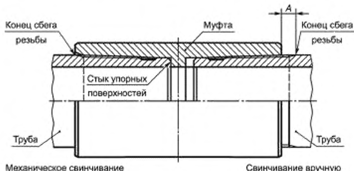
Рисунок 9 — Свинчивание трубы и муфты с резьбовым соединением ОТГ
