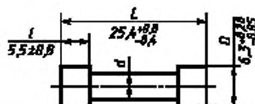
Рисунок 33 — Размеры цилиндрических плавких вставок (используемых в основном в электрических пробках)
