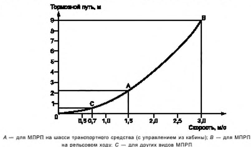
Рисунок 6 — Максимальный тормозной путь для МПРП типов 2 и 3 (см. 5.3.16)
