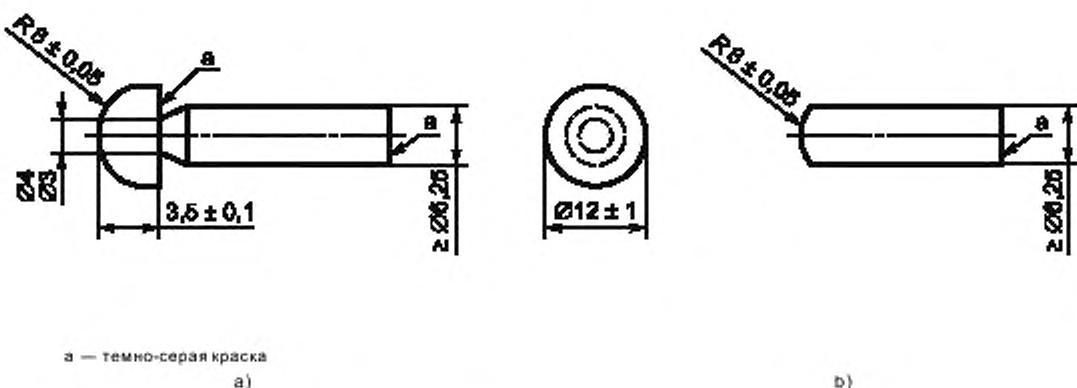
Приимечание — Коэффициент отражения окрашенной поверхности дна искусственного глаза должен примерно совпадать с коэффициентом отражения глазного дна.
