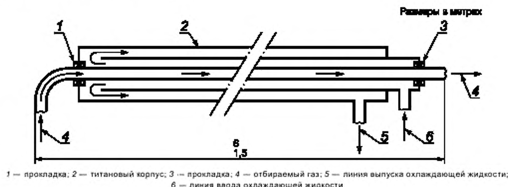
Рисунок В.8 — Пример охлаждаемого зонда
