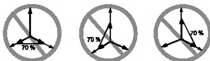
Рисунок 3 — Испытания трехфазных систем при воздействии провалов напряжения
