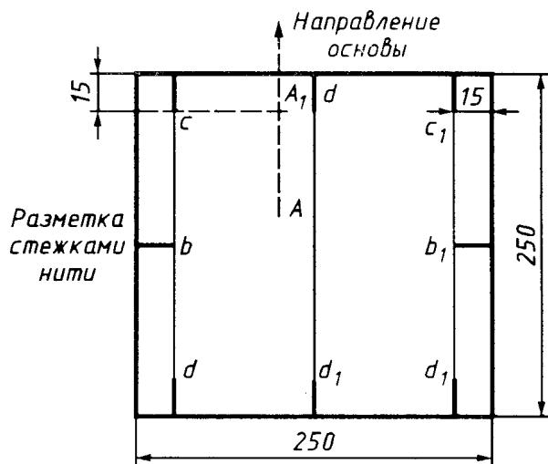
3.2. На точечную пробу накладывают верхнюю пластину шаблона, выкраивают элементарные пробы и размечают их стежками хлопчатобумажных ниток, цвет которых должен быть контрастным цвету ткани. Нитки с помощью швейной иглы продевают в прорези в шаблоне. Стежок закрепляют связыванием концов нити, не допуская при этом стягивания и излишней слабины. Длина стежка должна быть 15 мм. Контрольными должны быть крайние точки стежков, расположенные внутри квадрата.
