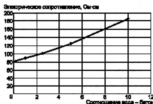
Рисунок 4 — Оценка электрического сопротивления водной вытяжки из бетона
