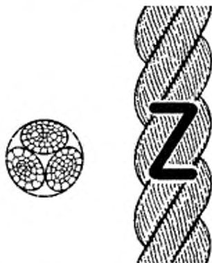
Рисунок 1 — Конфигурация 3-рядного крученого каната (тип А)
