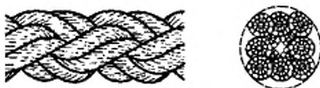
Рисунок 3 — Конфигурация 8-рядного плетеного каната (тип L)
