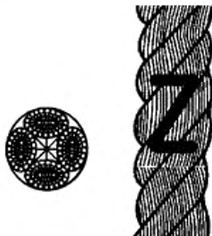
Рисунок 2 — Конфигурация 4-рядного крученого каната (тип В)
