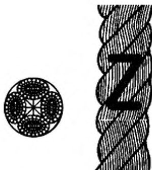
Рисунок 2 — Конфигурация 4-рядного крученого каната (тип В)
