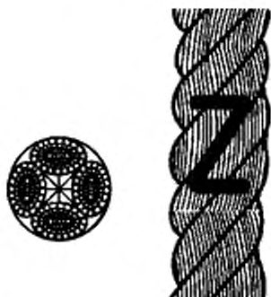
Рисунок 2 — Конфигурация 4-рядного крученого каната (тип В)
