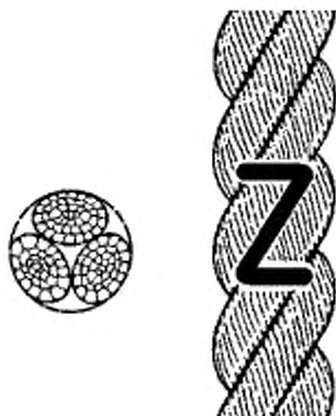
Рисунок 1 — Конфигурация 3-рядного крученого каната (тип А)
