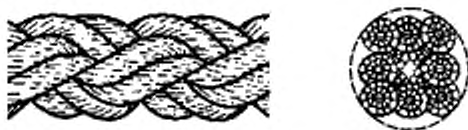
Рисунок 3 — Конфигурация 8-рядного плетеного каната (тип L)
