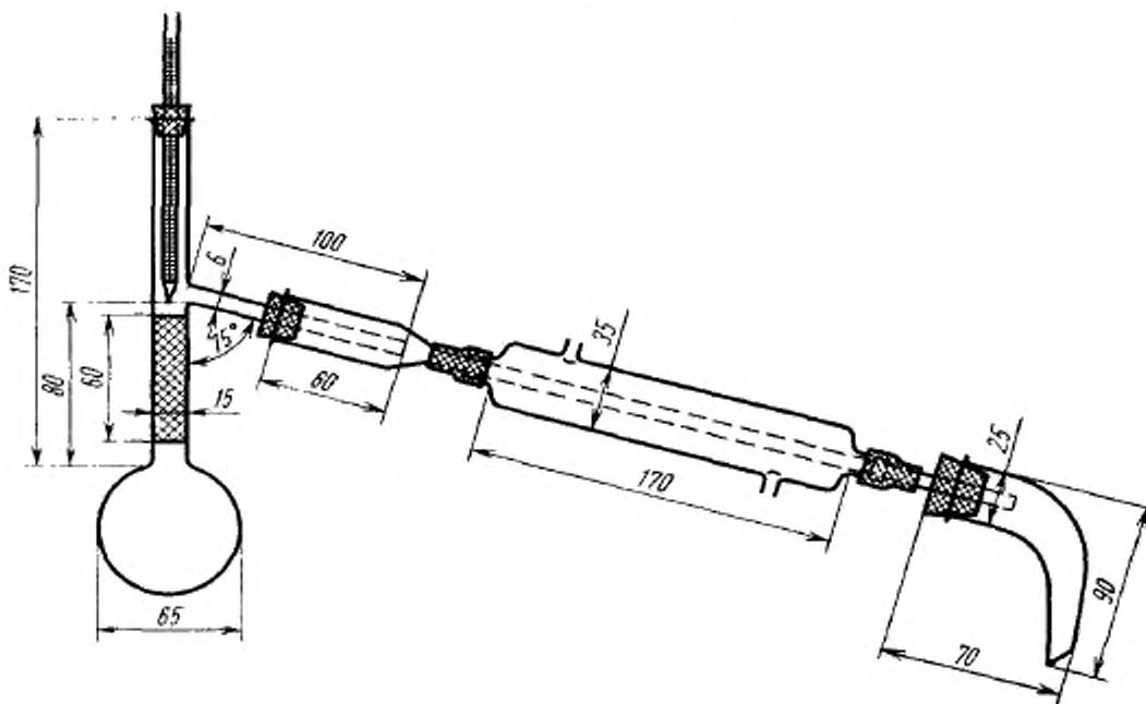
На конец холодильника надевают аллонж, под узкий конец которого ставят взвешенный цилиндр. Температуру измеряют термометром, укрепленным с помощью пробки в верхней части дефлэгматора.
