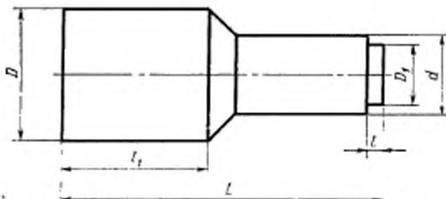
$D$ —диаметр блока детектирования;  $D_1$ —диаметр выступающих элементов в зоне размещения соединителей или кабелей;  $d$ —диаметр кожуха в зоне размещения электронной схемы;  $L$ —длина блока детектирования;  $l$ —длина выступающих элементов в зоне размещения соединителей или кабелей;  $l_1$ —длина части блока детектирования в зоне размещения счетчиков (счетчиков).
