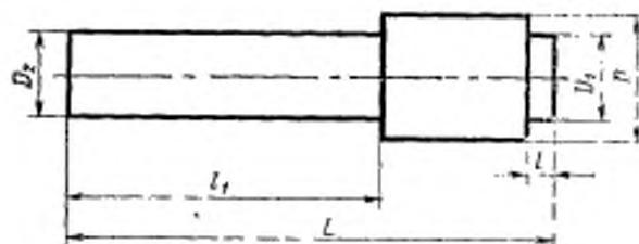
$D$ —диаметр блока детектирования;  $D_1$ —диаметр выступающих элементов в зоне размещения соединителей или кабелей;  $D_2$ —диаметр кожуха блока детектирования в зоне размещения счетчика;  $L$ —длина блока детектирования;  $l_1$ —длина выступающих элементов в зоне размещения соединителей или кабелей;  $l_2$ —длина части блока детектирования в зоне размещения счетчика.
