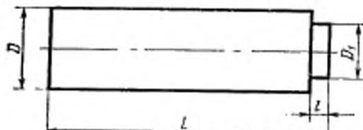
$D$ —диаметр блока детектирования;  $D_1$ —диаметр выступающих элементов в зоне размещения соединителей или кабелей;  $L$ —длина блока детектирования;  $l$ —длина выступающих элементов в зоне размещения соединителей или кабелей.
