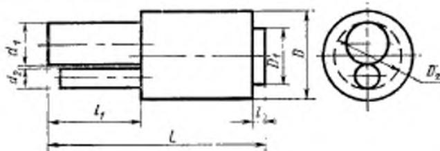
$D$ —диаметр блока детектирования;  $D_1$ —диаметр выступающих элементов в зоне размещения соединителей или кабелей;  $D_2$ —диаметр описанной окружности в случае размещения двух и более счетчиков;  $d_1$  и  $d_2$ —диаметры кожухов в зоне размещения двух счетчиков;  $L$ —длина блока детектирования;  $l_1$ —длина выступающих элементов в зоне размещения соединителей или кабелей;  $l_2$ —длина части блока детектирования в зоне размещения счетчика (счетчиков).
