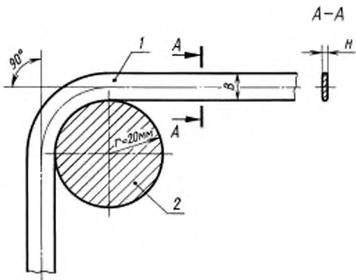
1.3. Образцы плющеной ленты должны выдерживать испытание на ребровый изгиб в положении, показанном на черт. 1. Угол изгиба принимается равным 90°.
