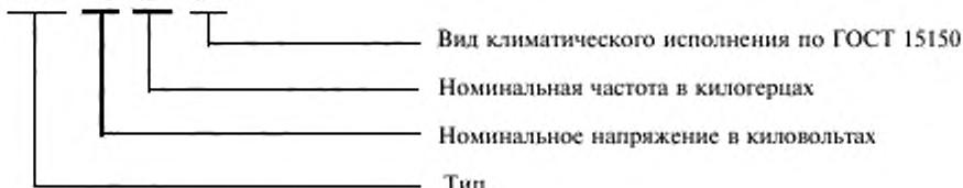
П р и м е ч а н и е . В условные обозначения типономинала конденсаторов допускается включать дополнительные информационные данные.
