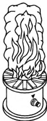
Рисунок В.2 — Расположение берёзовых брусков при проведении испытаний на чувствительность к тестовому очагу пожара ТП-2
