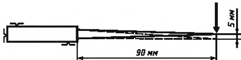
Рисунок 1 — Схема проведения испытаний на прочность и упругость охотничьих ножей
