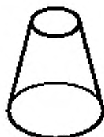
Пример 3 — Осевая симметрия; в данном случае — относительно линии пересечения плоскостей симметрии примера 1 (10 ненулевых элементов; 6 различных значений)
