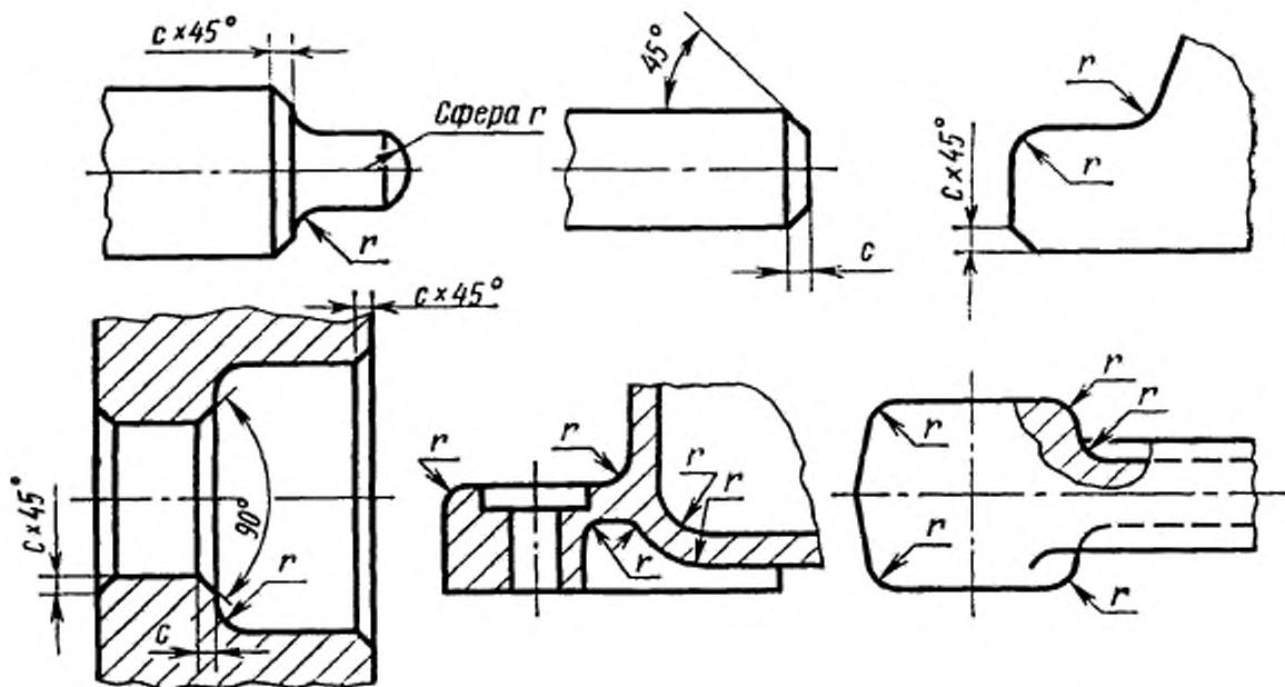
Примечание. В обоснованных случаях допускается применять фаски с углами, отличными от 45°.
