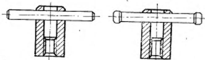
**Изменение № 2 ГОСТ 13427—68 Гайки с отверстием под рукоятку для станочных приспособлений. Конструкция и размеры**
