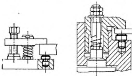
Изменение № 2 ГОСТ 13440—68 Опоры постоянные с плоской головкой для стаканочных приспособлений. Конструкция и размеры
